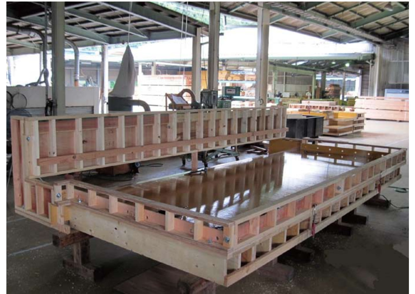
■手すり型枠(マンション用)
